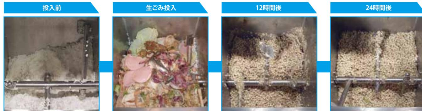
筐体内の適切な温度・湿度管理により、微生物が微生物ハウスに生息している最適な状態です。
